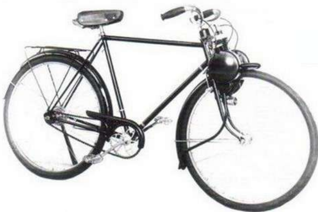
Le tout premier prototype, sur un cadre fermé de vélo Aleyon, date de 1941; Le phare est monté sous le moteur.
